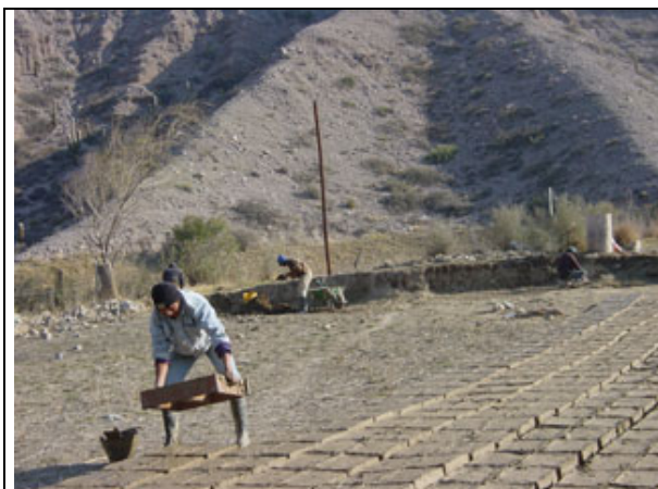
Die Erdbausteine werden mit Gras gemischt und nun an der Luft getrocknet
